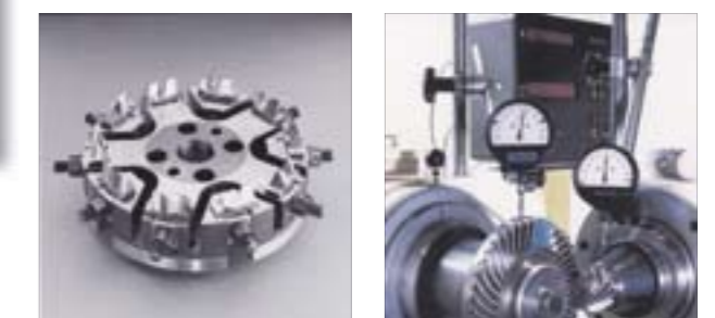
Rechts, Qualitätskontrolle : Bei der Einflankenwälzprüfung wird die Verzahnungsqualität im Einbauzustand geprüft und dokumentiert.
