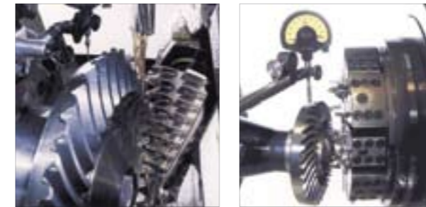
Links, Herstellung eines Palloid-Zahnrades im Abwälzkopf-Fräsverfahren.
