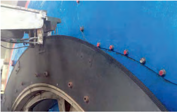
Vorher: Optische Zahnradabtastung / Before: Optical tooth wheel scanning
