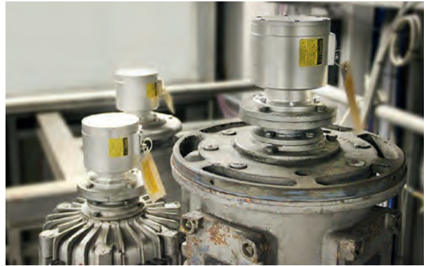
Nachher: Inkrementale Drehgeber / After: Incremental encoders
