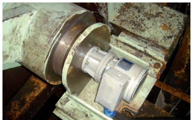
Nachher: Looper-Drehgeber / After: Looper encoder
