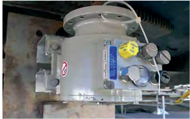
Nachher: Permanente Positionsmessung mit einem sicherheitszertifizierten Absolutwert-Drehgeber / After: Permanent position measurement with one safety-certified absolute encoder
