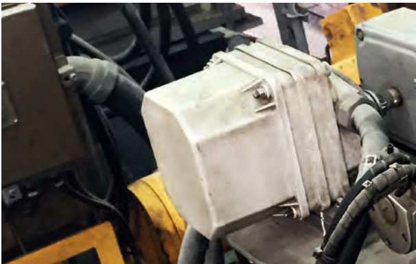
Vorher: Mechanisches Kopierwerk / Before: Mechanical cam limit switch
